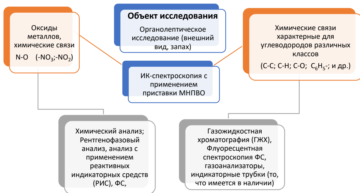
Рис. 1. Схема исследования образцов на предмет наличия зажигательных составов и инципаторов горения
